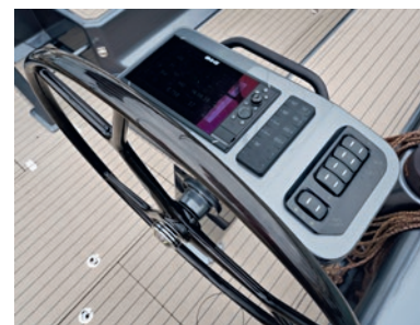
▲ Kipparin ei tarvitse kahvoille kurkotella, kun pedestaalissa on katkaisijat tärkeimpien trimmien sähkövinsseille plotterin ja valokatkaisinten lisäksi.
