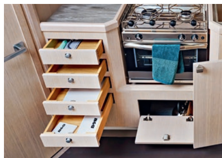
▲ Kalusteiden komposiitissa hiilikuitu on vaihdettu pellavaan ja pinnoite on tammiviilua.
